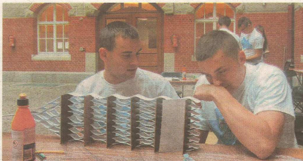
► Barlewicki most płytowy wykonany przez uczniów został nagrodzony. Dobrze wypadł w testach wytrzymałościowych. Wytrzymał obciążenie ponad 200 kilogramów!
